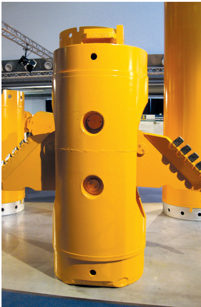
Pfahlfussaufschneider mit Schneidarmen Belling buckets with cutting arms
