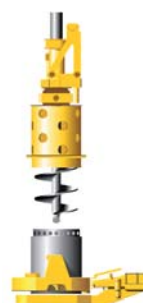
Verrohrtes Kellybohren (Rohreinbau mit BV)
